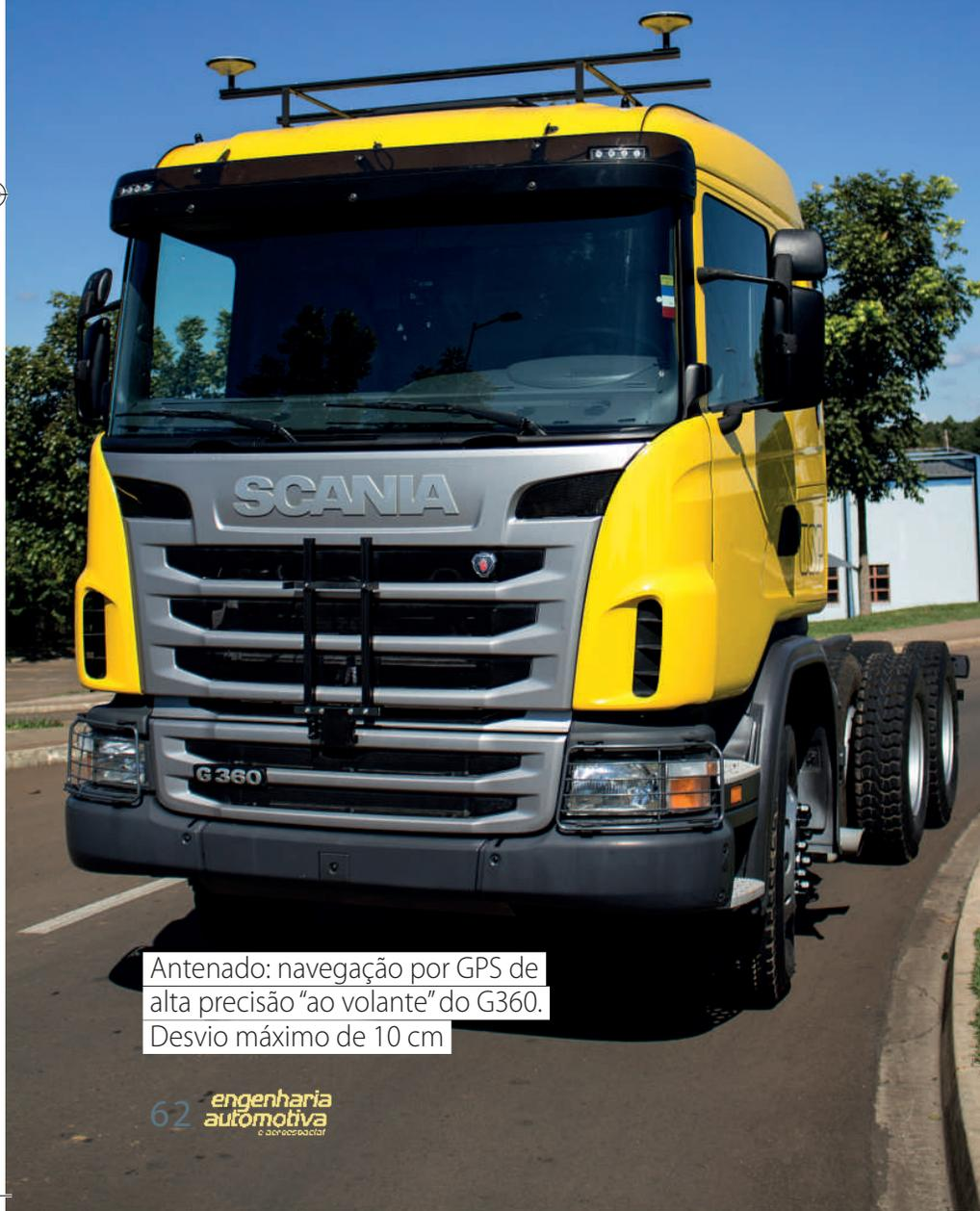
Antenado: navegação por GPS de alta precisão “ao volante” do G360. Desvio máximo de 10 cm
